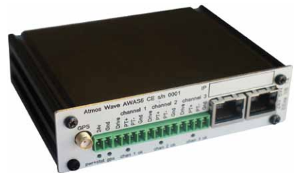
Рис. 1. AWAS-6 – модуль сбора данных COY Atmos Wave Flow
